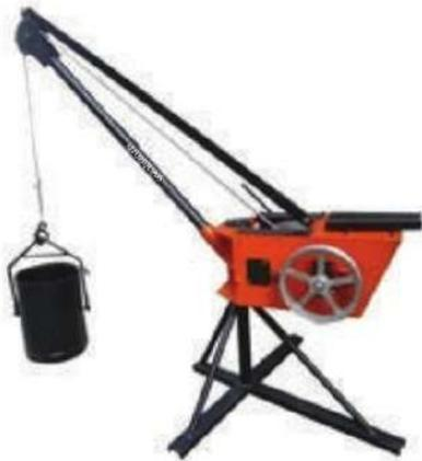
Equipo indispensable, en lo que a levante de carga se refiere. Sistema de Freno predispuesto de dos zapatas calzadas con balde de 70L, 30M de guaya, guardapolea. Con Motor diesel de 10 Hp , motor gasolina de 9 hp. Con motor eléctrico trifásico de 5 hp.
