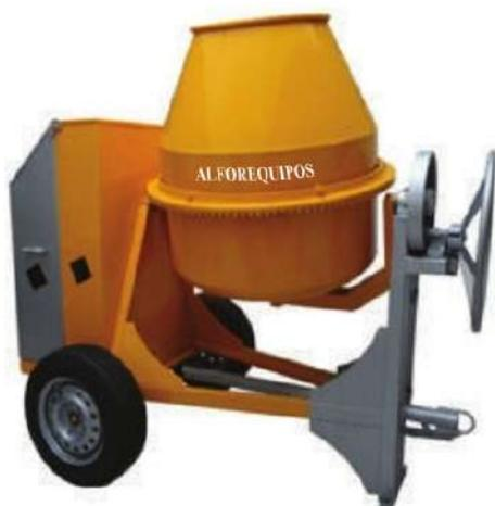
Catalina y cremallera de diente interno acerada, libre de mantenimiento. Fondo formado y rebordeado en plancha de acero, con 4 aspas para mezclado, eje del tambor 1 ½" de diámetro, eje del piñón de mando 1 ¼" con piñón cónico, bastidor con canal estructural, barra de tiro de 2", telescópica desmontable.
