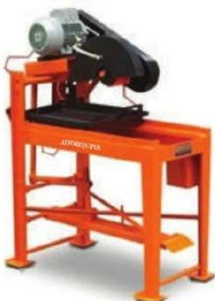
Está diseñada para realizar cortes en serie a diferentes ángulos y profundidades con un máximo seguridad. Sistema de refrigeración: Bifocal tipo flauta facilitan la refrigeración del disco por las dos (2) caras de forma ideal.
